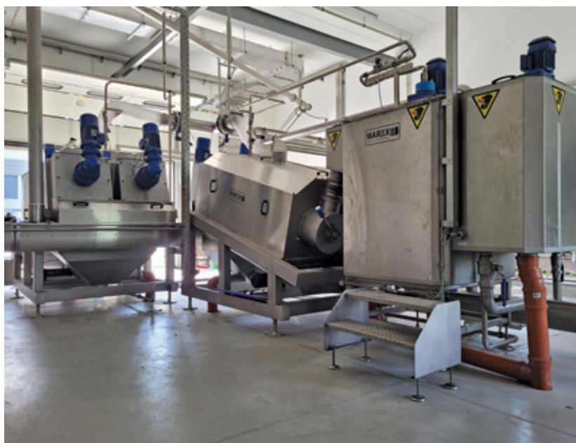
Fot. 6. Prasy śrubowo-talerzowe w oczyszczalni ścieków „Zamienie”
